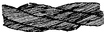
Рис. 1. Обрывы и смещения проволок каната крестовой свивки
