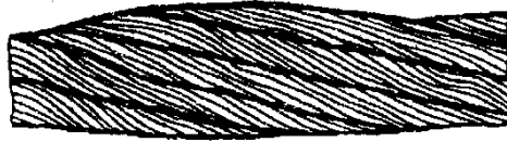
Рис. 13. Местное увеличение диаметра каната
